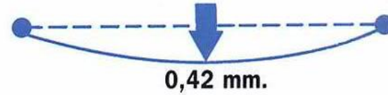
Ford Escort. Una flexión de 0,42 mm. no está mal para un cuatro plazas.
