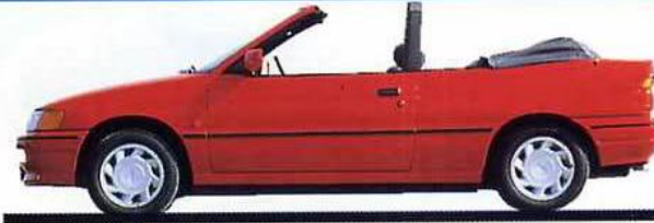
Ford Escort. Una flexión de 0,42 mm. no está mal para un cuatro plazas.
