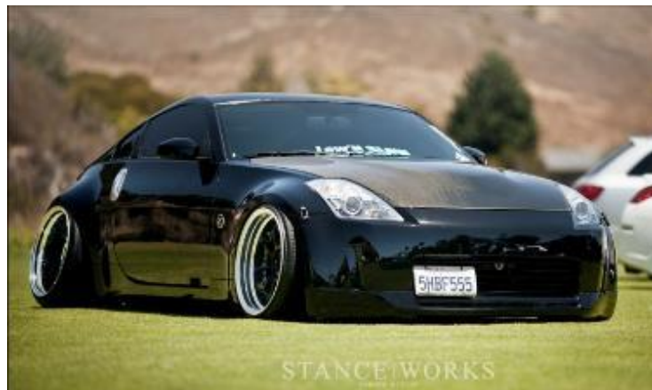
Figura 10 Angulo exagerado de Camber en un vehículo.
