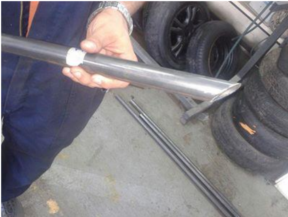
Figura 25 Preparación de los Perfiles Método de Soldadura
