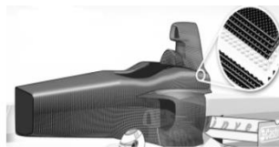
Figura 2 Monocasco de Fibra de Carbono de un Fórmula 1
