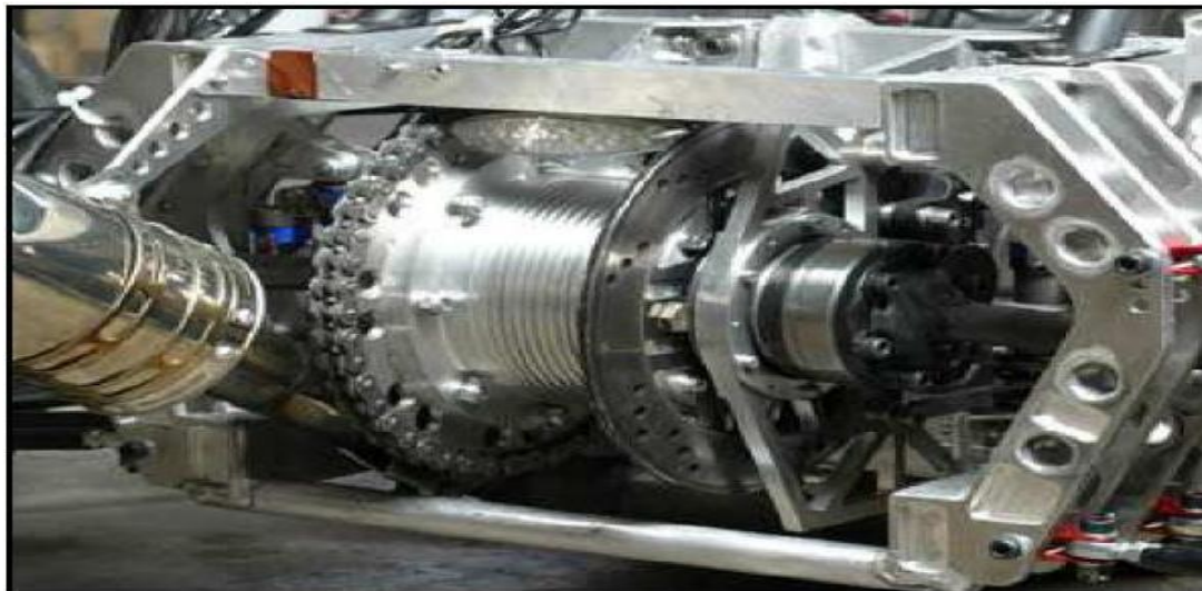
Figura 15 Configuración de mono disco trasero acoplado a la carcasa del diferencial autoblocante
