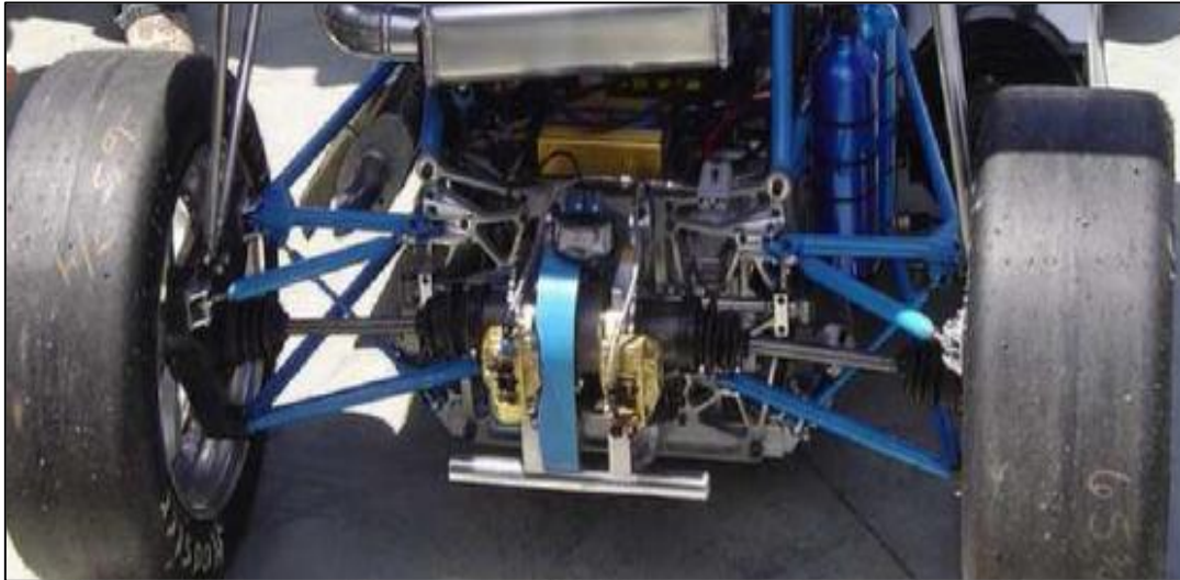
Figura 14 Configuración de dos discos traseros interiores
