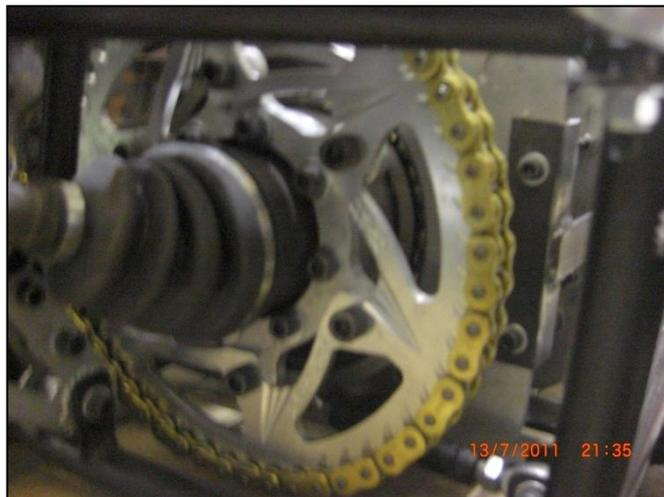
**Fig. 3.26 Refuerzos en la caja de transmisión**
