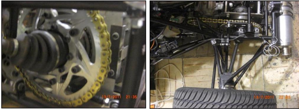
**Fig. 3.24 Vista lateral y superior del sistema de transmisión**
