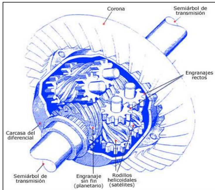
**Fig. 2.32 Vista en corte de un diferencial Torsen**
