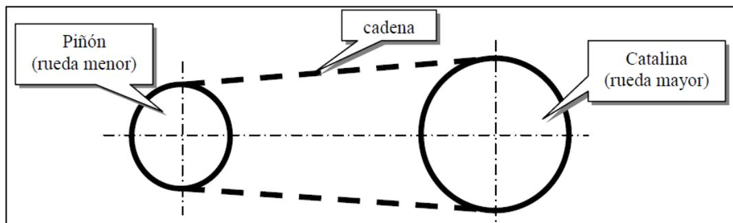
**Fig. 2.2 Esquema básico de una transmisión por cadenas.**
