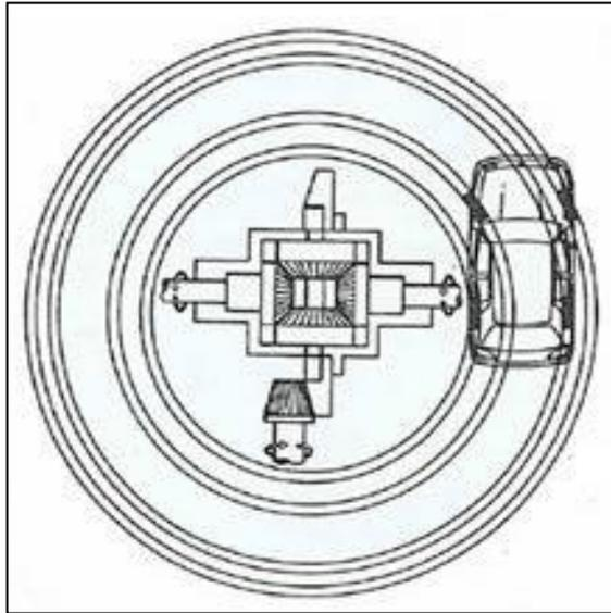
**Fig. 2.22 Esquema del diferencial y su función**
