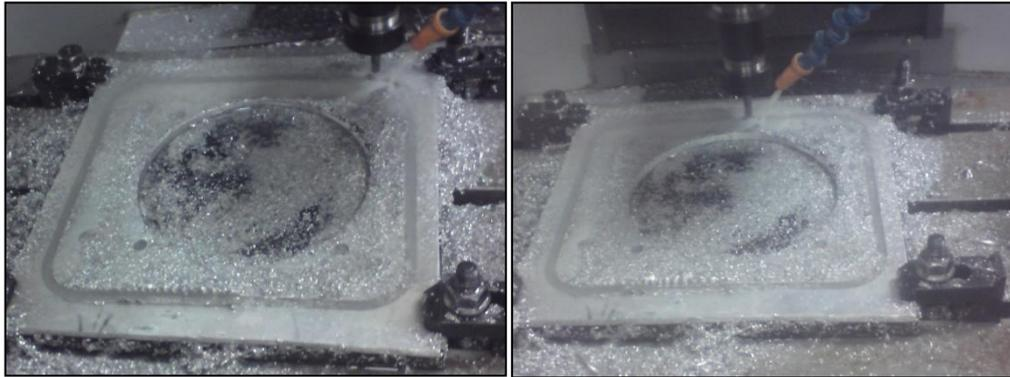
**Fig. 3.15 Tapa de rodamiento grande**
