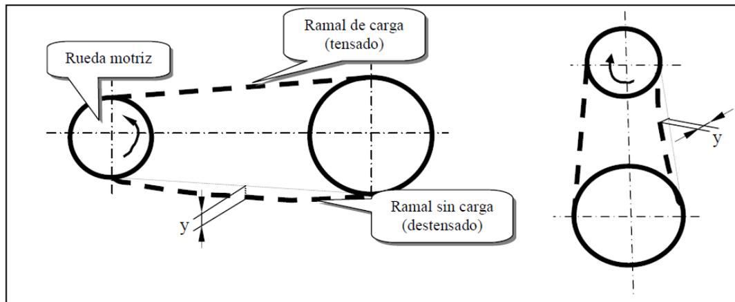
**Fig. 2.3 Tensado adecuado de la cadena en una transmisión. Para un montaje horizontal con cargas de impacto se recomienda  $y = (0,02...0,01) \cdot a$ , con carga suave  $y = 0,04 \cdot a$ . Para un montaje vertical se orienta  $y = 0,01 \cdot a$**
