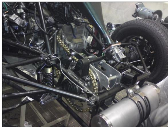
**Fig. 3.23 Ensamblaje total del sistema de transmisión**
