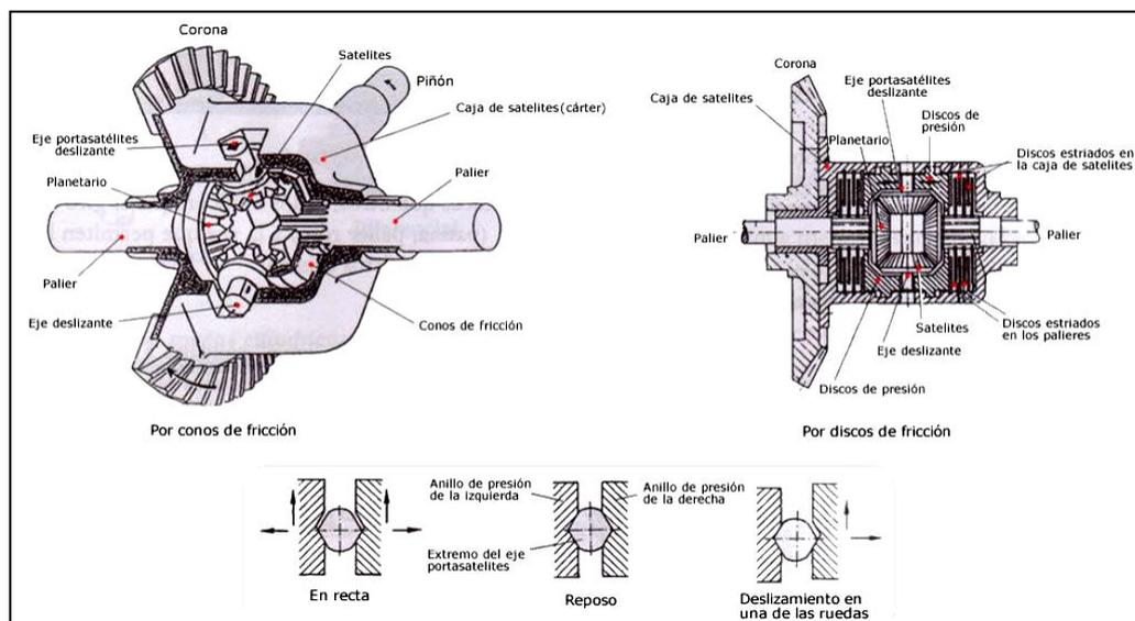
**Fig. 2.24 Detalle del posicionamiento del eje deslizante**
