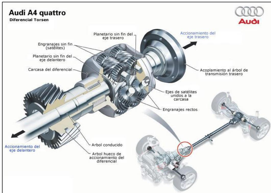
**Fig. 2.37** Situación del Torsen en una transmisión quattro
