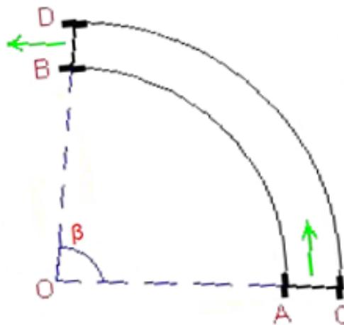
**Fig. 2.6 Recorrido de los neumáticos en una curva**
